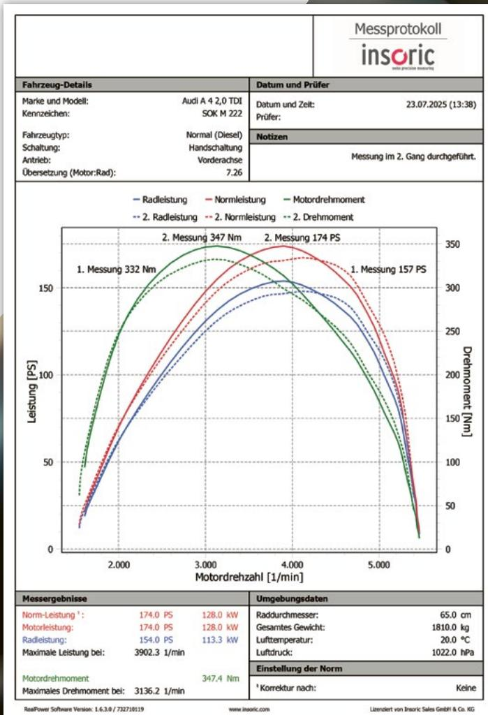
Em 22/07 foi realizada a primeira medição (linha tracejada). Em seguida, o tanque de combustível foi abastecido com 300 ml do nosso **HIGTEC PREMIUM CLEANER DIESEL** (Nº art.: 23063) e completado com combustível até a capacidade total.
