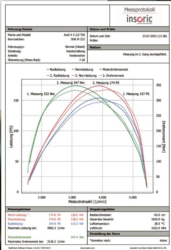
El 22 de julio se realizó la primera medición (línea discontinua). A continuación, se llenó el depósito de combustible con 300 ml de nuestro **HIGTEC PREMIUM CLEANER DIESEL** (Referencia: 23063) y se llenó el depósito.
