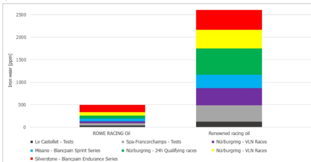
Диаграмма (см. выше) показывает износ железа за несколько гонок / испытаний. Износ железа при использовании именитого масла для гоночных автомобилей (справа) показывает уже после 3 заездов более высокий износ, чем при использовании масла ROWE RACING (слева) после всех 7 гонок / испытаний.
