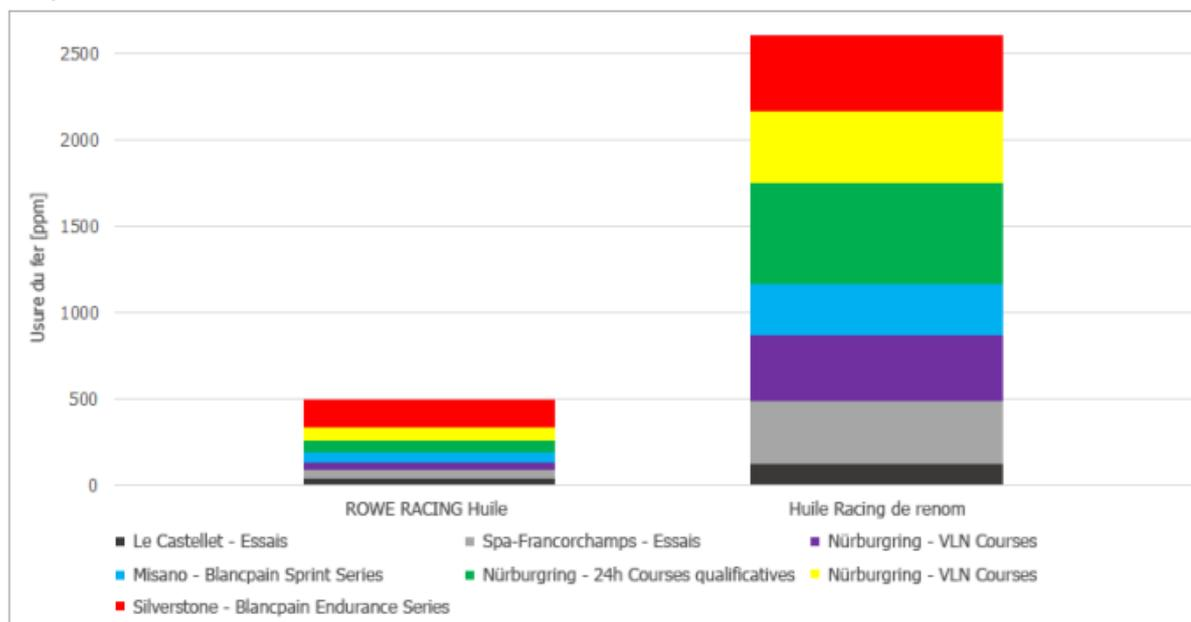
Le diagramme (ci-dessus) montre l'usure du fer cumulée sur plusieurs courses/essais routiers. L'usure du fer, avec l'utilisation de l'huile Racing de renom (à droite) démontre, dès le 3ème course, une usure plus élevée qu'avec l'huile ROWE RACING (à gauche) après l'ensemble des 7 courses/essais routiers.
