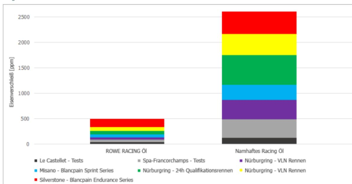
Das Diagramm (oben) zeigt den Eisenverschleiß kumuliert über mehrere Rennen/Testfahrten. Der Eisenverschleiß bei Einsatz des namhaften Racing Öles (rechts) zeigt bereits nach dem 3. Lauf einen höheren Verschleiß als bei Einsatz des ROWE RACING Öles (links) nach allen 7 Rennen/Testfahrten zusammen.
