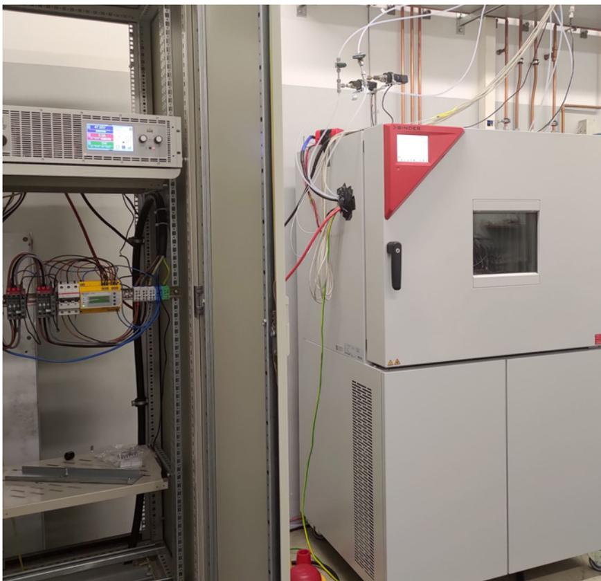
Abb. 2: Umgesetzter Aufbau des Prüfstandes mit bidirektionalem Labornetzteil, Temperatorkammer und Flüssigkeitskonditionierer (von links nach rechts)
