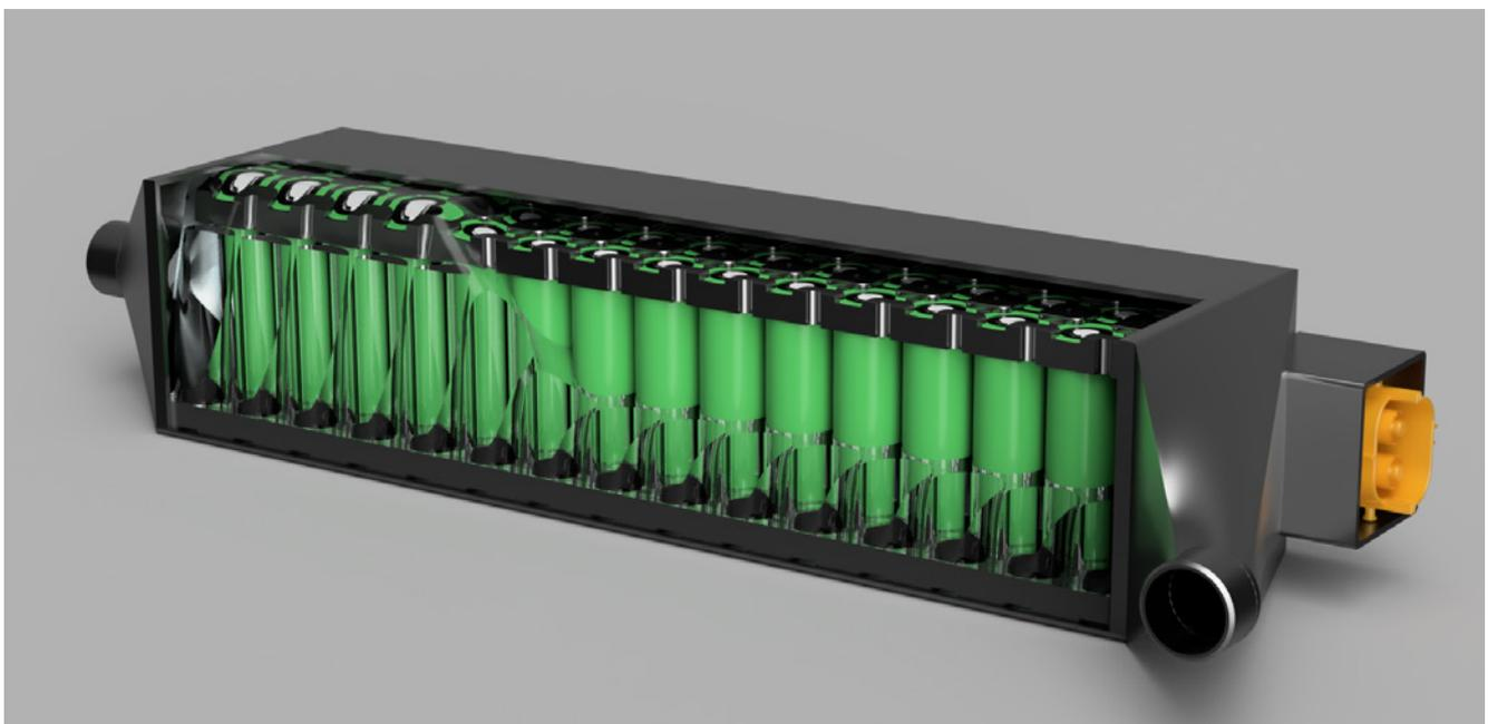
Immersione Batteriekühlung mit einem dielektrischen Fluid
